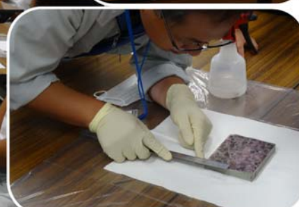
写真 3-3 実習（コンクリートの耐久性試験）の状況
