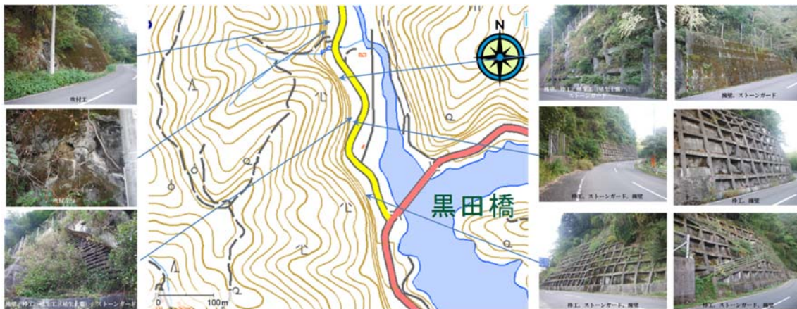
図 4 湯山柳斜面 (写真 左上：吹付工、中：吹付工 (近影)、下：砕内緑化工、右上：擁壁、ストーンガード、砕工、砕内緑化工、中：擁壁、ストーンガード、砕工、下：砕工、擁壁、ストーンガード)
