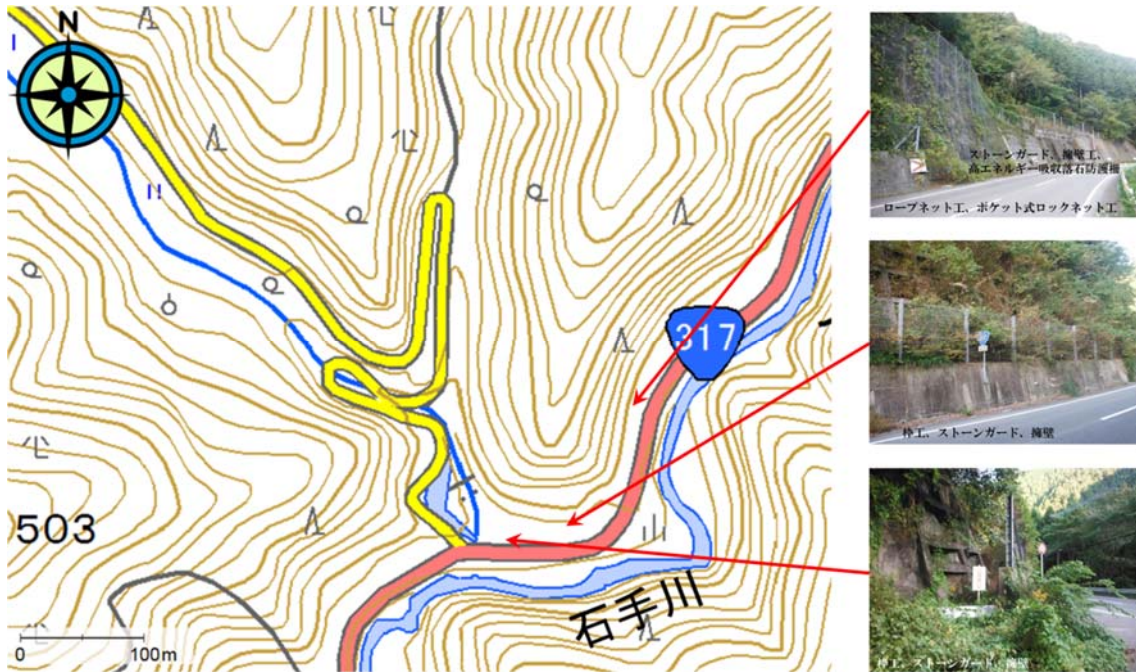
図 6 東川斜面 (写真 右上：高エネルギー吸収落石防護柵、ストーンガード、擁壁工、ロープネット、ポケット式ロックネット、中：砕工、ストーンガード、擁壁、右下：砕工、ストーンガード)
