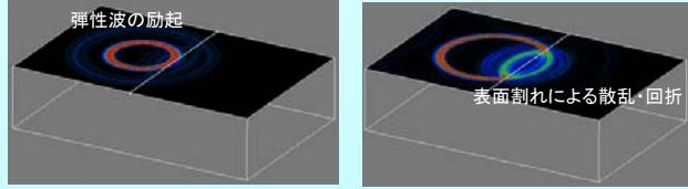
上図は、動弾性有限積分法(Elastodynamic FIT: EFIT)による弾性波の伝搬解析の例。表層のき裂の深さを弾性波の透過振幅から推定する。EFITは陽解法であるので、並列化効率が良好であることが、H23,H24年度学際大規模情報基盤共同利用・共同研究拠点で示された。H25年度は現実的な形状・大きさをモデル化するための大規模計算を予定している(数十億ボクセル規模)。
