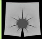
コンクリート、鉄筋、そして両材料間で付着領域として3相に分け、コンクリート材料中への塩化物イオンの拡散問題と鉄筋膨張に伴うき裂進展を含む力学問題の連成解析を実施する。非定常拡散解析と非線形有限要素解析を連成させて解く。数百万から数千万要素規模の解析を予定している。
