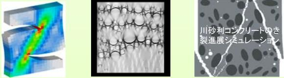
有限要素法(FEM)、拡張有限要素法(X-FEM)、有限被覆法(FCM)等のモデル化手法を用いて、コンクリート中のき裂進展解析を実施する。ここでは、コンクリート中の骨材分布を考慮し、破壊力学に基づくき裂発生・進展のモデル化を行う。これを大規模数値シミュレーションへと発展させる。陰的解法であるが、数千万要素規模の解析を目指したい。
