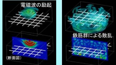
左図は、電磁界有限積分法(Electromagnetic FIT: EMFIT)による床版の電磁波の伝搬解析の例。鉄筋や塩ビ管の位置・分布形態を電磁波の散乱波形から映像化する。EMFITは陽解法であり、EFITと同じスキームでコードィングされているため、並列化効率は良好である。H25年度は現実的なモデル化のための大規模計算を予定している(数十億ボクセル規模)。
