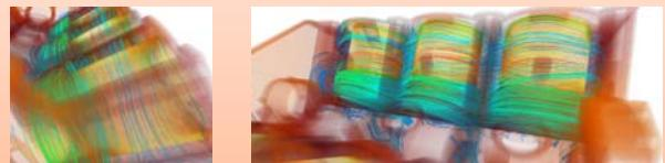
膨大な入力・出力データを効率的に扱うための技術を提供する。また、計算結果を3次元的に可視化し、視覚的にわかりやすく描画するため技術の実装をサポートする。上図は、有限要素法の計算結果を可視化(応力テンソルの超流線の表示)した例。
