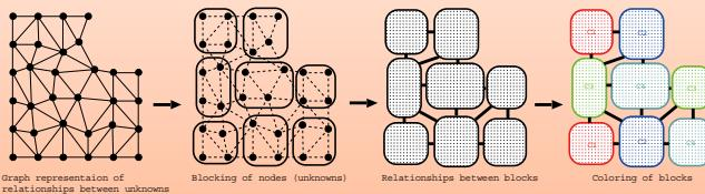
高性能線形ソルバに関する技術を提供し、スレッド並列・プロセス並列に対応した陰的解法による大規模計算の高度化を行う。上図は、マルチスレッドICCGソルバで利用される代数ブロック化多色順序付けの概念図。
