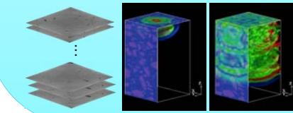
微小き裂群の開閉口に伴う非線形超音波を検出することで、コンクリート自身の強度・健全性を評価する。材料非線形性あるいは境界非線形性を考慮した動的有限要素解析の適用を予定。
