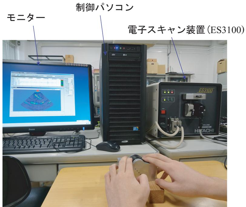
図4 超音波電子スキャン装置と計測風景
