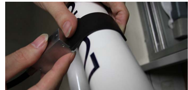
可撓性アレイプローブ (直径30mmの自転車フレームに接着)
