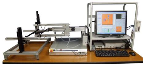
ジャパンプローブ(株) 非接触空気超音波探傷システム
