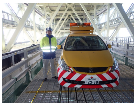
点検に使用する道路維持作業車(黄パト)
